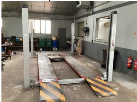
47 -Pont quatre colonnes CASCOS 5 T de 2012 avec pont intermédiaire
