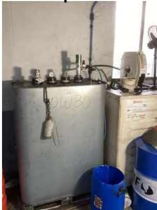
63 - Cuve capacité 1000 L pour huile moteur 0w30 avec un pistolet et un dérouleur
