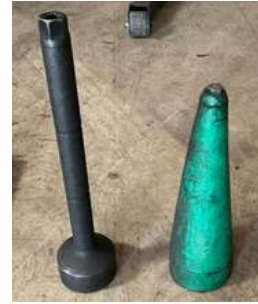
Lot 93 - Cône pour soufflet de cardan et clé pour rotule axiale
